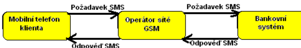
Obr. č. 4 Schéma komunikace klienta s bankou pomocí GSM. Zdroj: [4]
