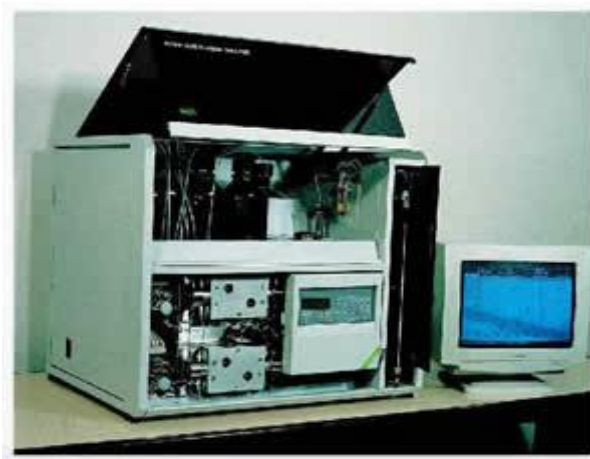
Obrázek 12. Automatický analyzátor aminokyselin AAA 400 [64]
