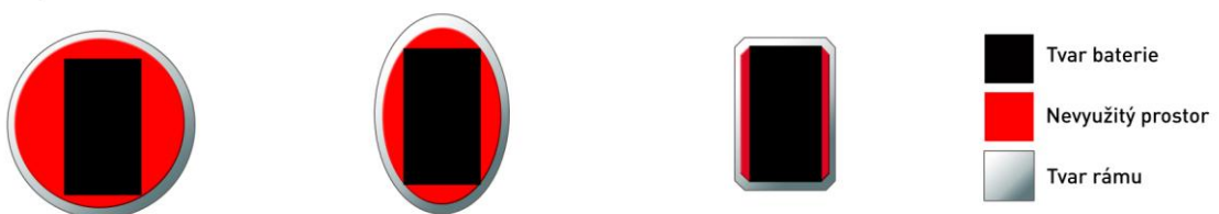
Obr. 42. Ukázka řešení profilu rámové trubky
