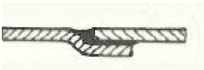
Obr. 15 Promáčknutý překlátovaný spoj [1]
