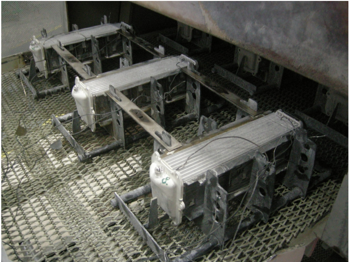
Obr. 31 Pájecí konfigurace pro tři kusy výměníku
