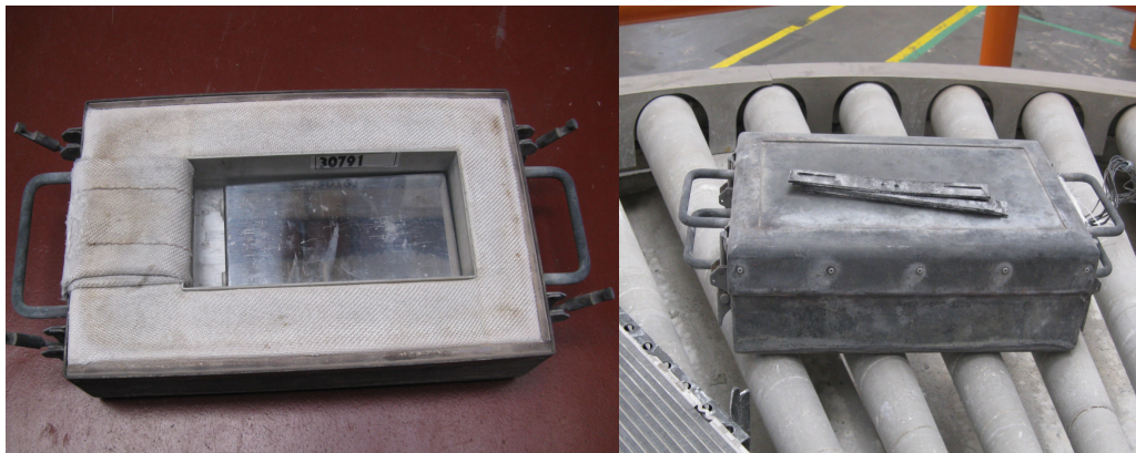
Obr. 24 Ochranná schránka s otvorem pro datovou paměť a před průjezdem pecí
