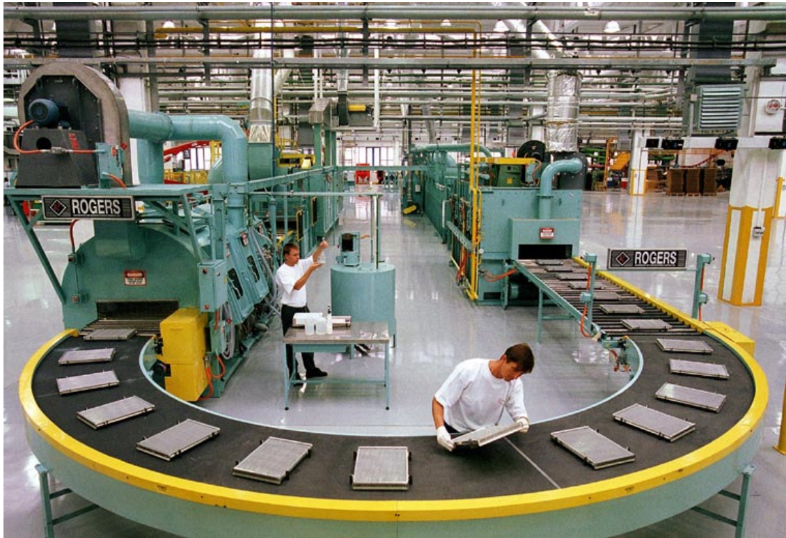
Obr. 21 Průběžná pájecí pec pro tvrdé pájení hliníku v ochranné atmosféře dusíku.
