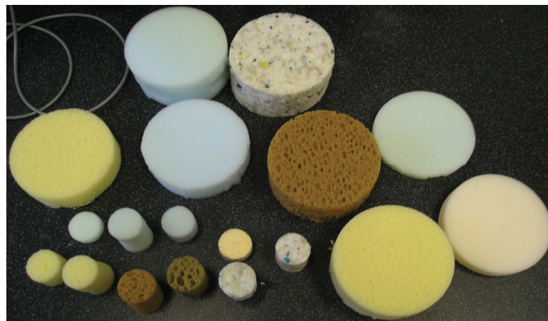
Obr. 16. Připravené vzorky k měření zvukové pohltivosti.
