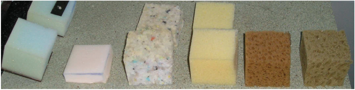
Obr. 14. Připravené vzorky k měření přenosového útlumu.
