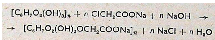
Obrázek 2 – Reakce vedoucí ke vzniku karboxymethylcelulózy [6]
