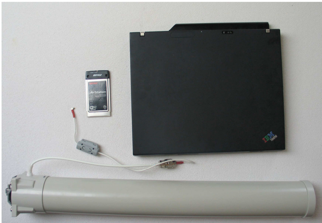
Obr. 14 Použitá sestava pro skenování bezdrátové sítě
