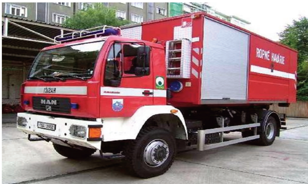
Obrázek 12.: Zásahové vozidlo pro ropné havárie
