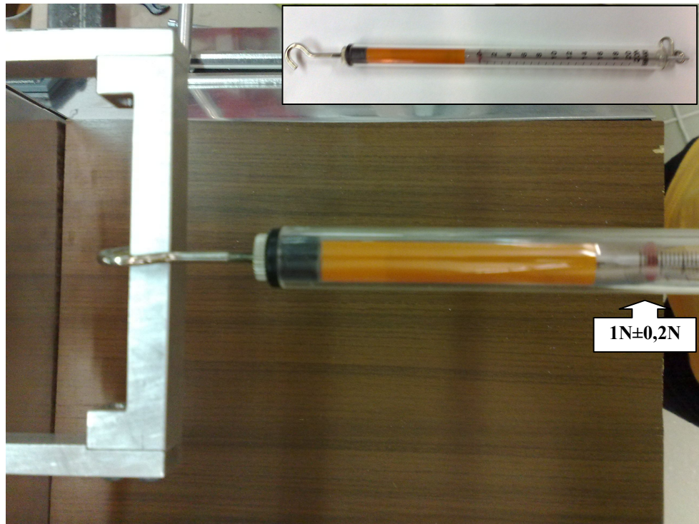
Obr. 47. Kontrola působení síly 1\text{ N} \pm 0,2\text{ N} pružinovým siloměrem
