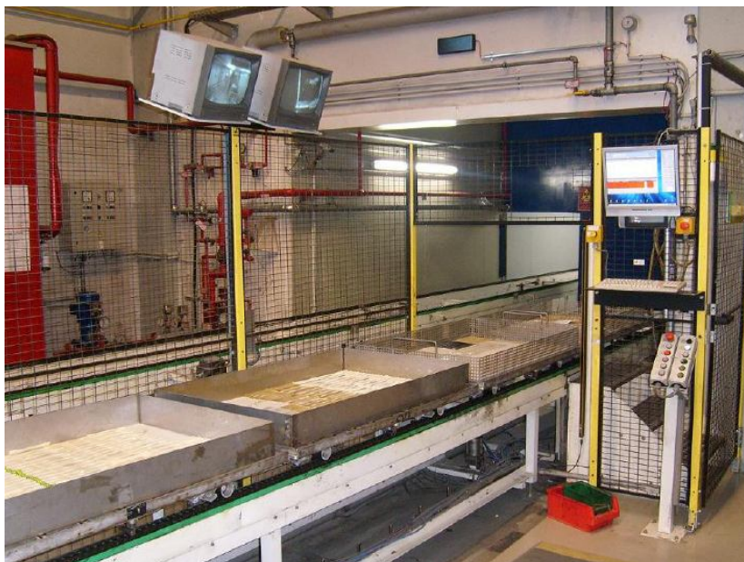
Obr. 22. Linka pro ozáření ve firmě BGS
