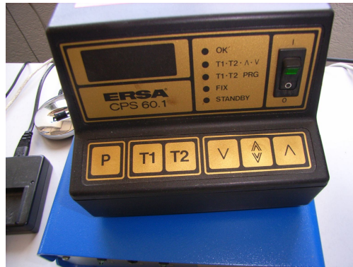
Obr. 24. Zařízení od ERSA na Soldering iron test
