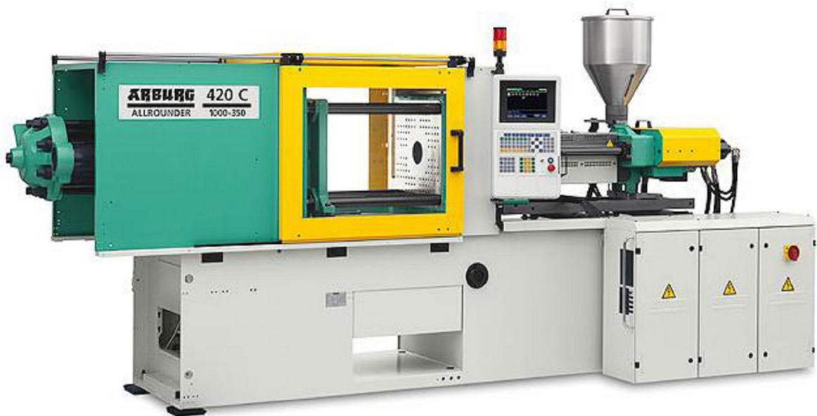
Obr. 17. Vstřikovací stroj ARBURG 420C Allrounder Advanced
