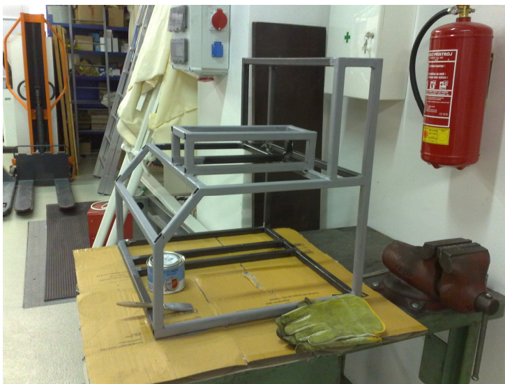
Obr. 35. Rám přístroje v základové barvě
