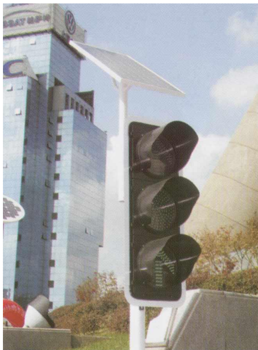
Obrázek 24. Semafor s úspornými diodami napájený solárním panelem. [3]
