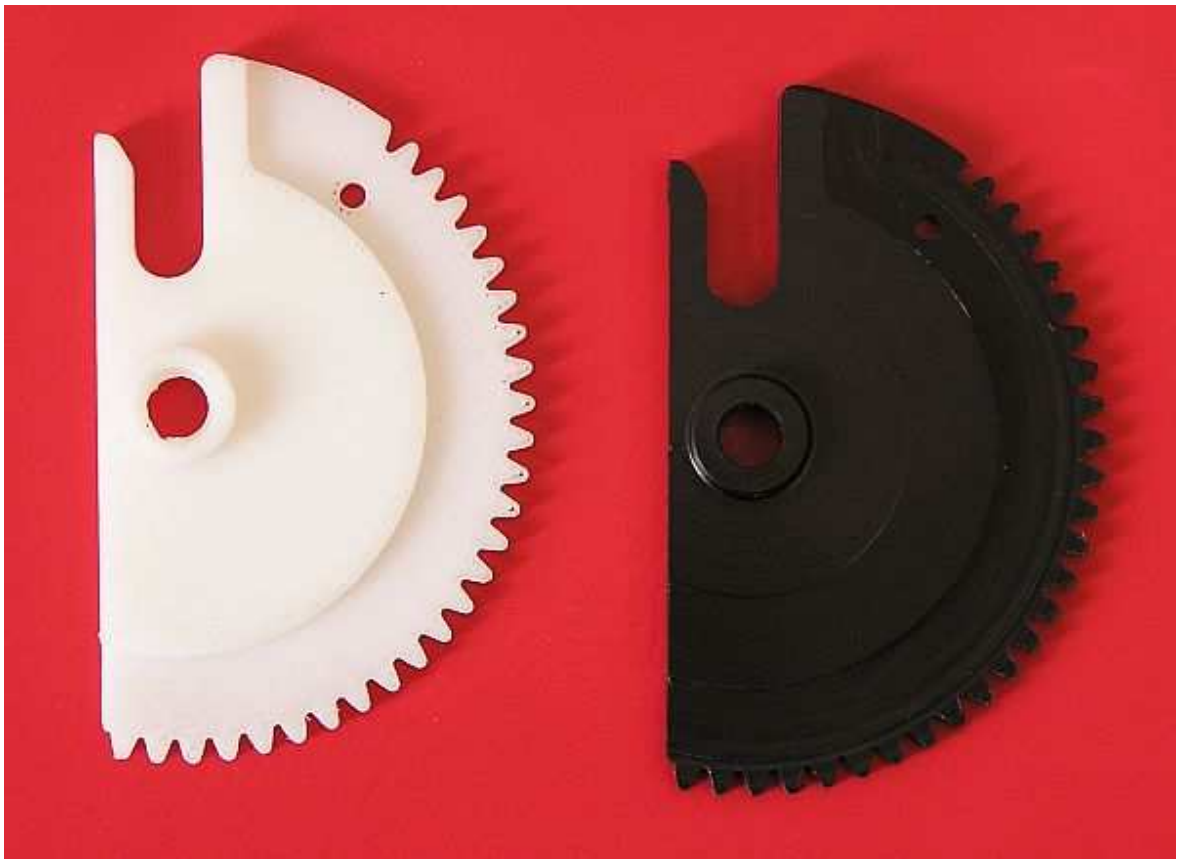
Obr.22 Porovnání dílů zhotovených technologiemi RP (vlevo) a CNC (vpravo)
