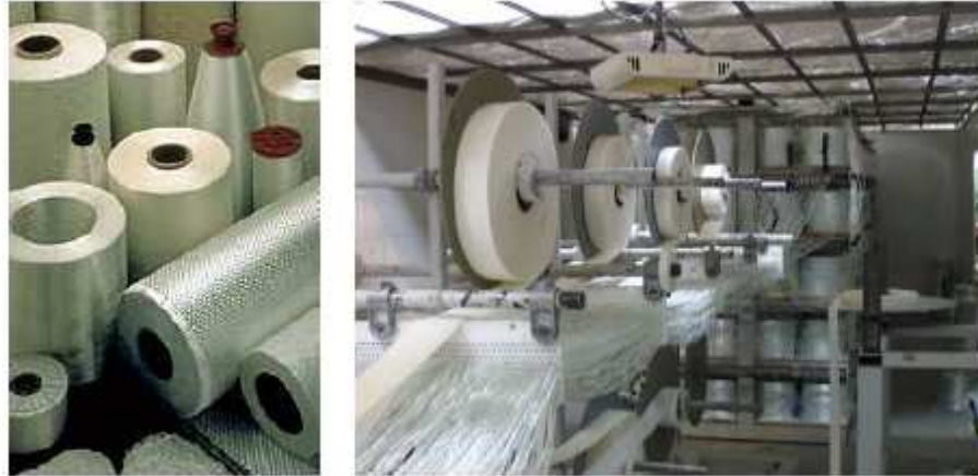
Obrázek 18 Sklená vlákna ve formě rovingu a tkací stroj používaný na výrobu kompozitů [10]
