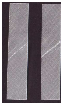
Obrázek 42 Charakteristické porušení vzorku při zatížení ve směru 45°
