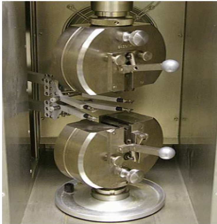
Obr. 27 Zkušební stroj Zwick 1456- čelisti a extenzimetr
