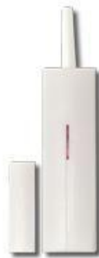
Obrázek 4: Ukázka bezdrátového magnetického kontaktu od spol. Jablotron; zdroj [14]
