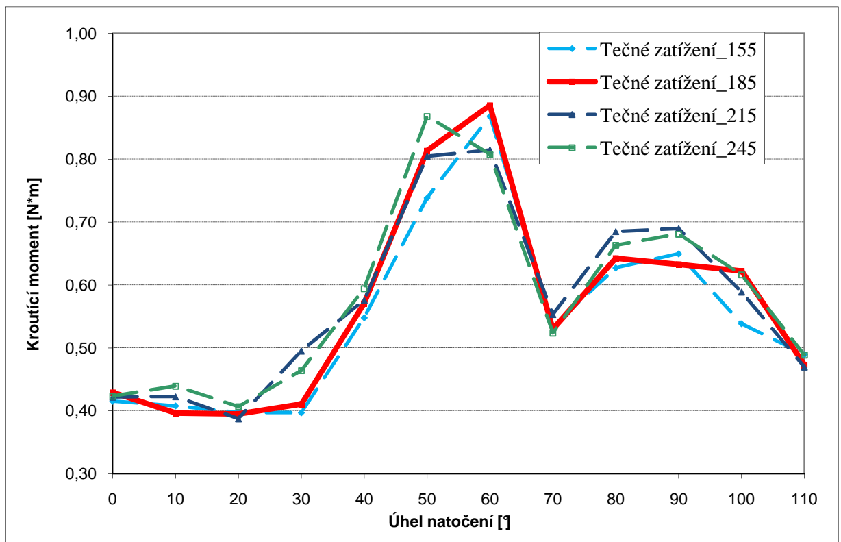
Obr. 69. Závislost M_k na úhlu natočení při různých hodnotách tečného zatížení.
