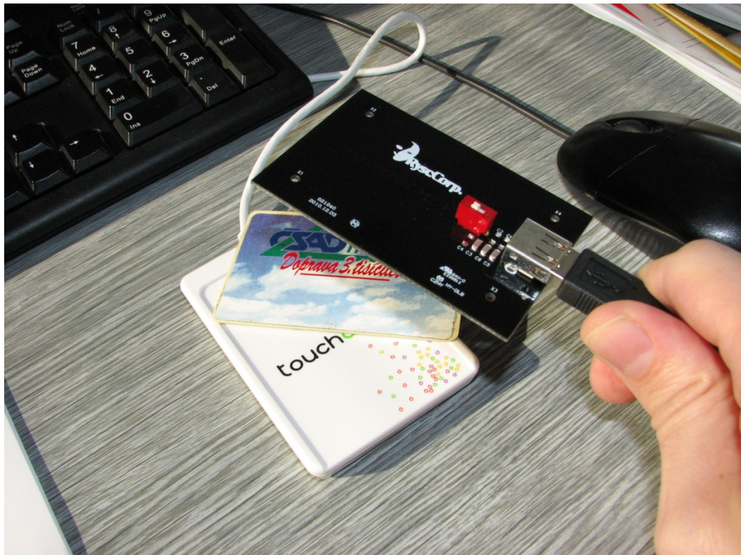
Obr. 26. Zachytávání komunikace Mifare classic čipové karty CSAD.
