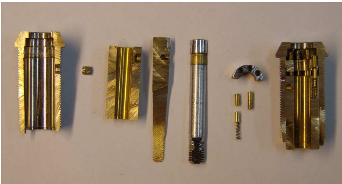
Obrázek 11 Trubkový zámek - řez
