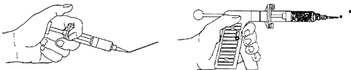
Obr. 4 Nanášení pájecí pasty dispenzerem
