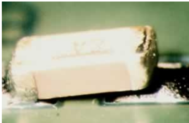
Obr. 37 Tombstoning efekt zvaný drawbridging
