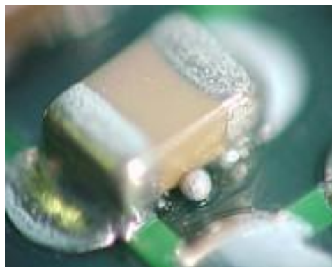
Obr. 30 Další porucha Solder Beads
