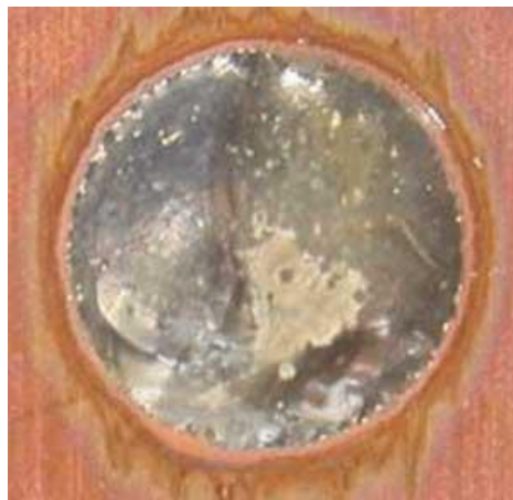
Obr. 32 Dobrý pájený spoj
