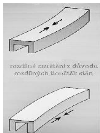
Obrázek 11 Vliv smrštění na kvalitu výrobku (lunkr, vtaženina) [12]
