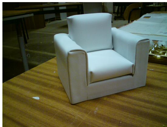
Obr. 6. Křeslo po potažení kůží
