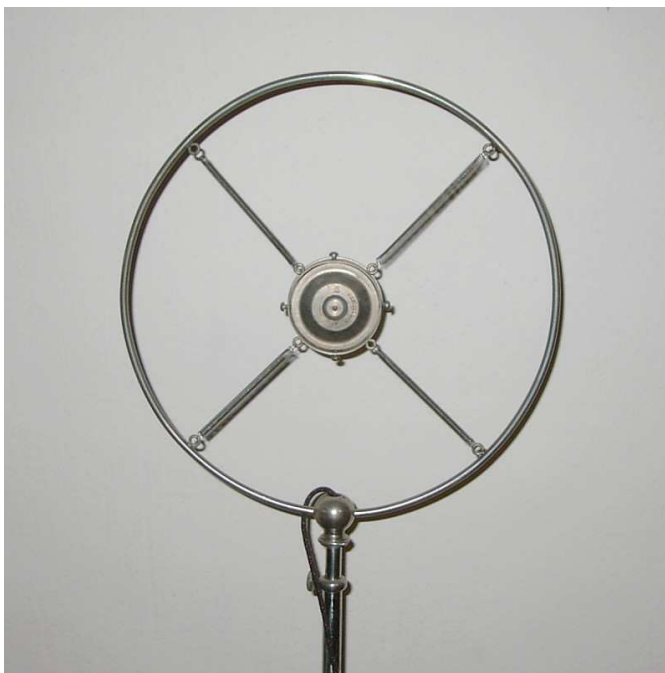
Obr. 1. uhlíkový mikrofon firmy Ericsson užívaný ve 20. a 30. letech 20. století
