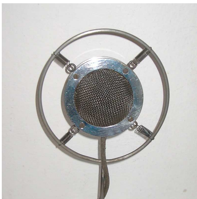
Obr. 2. Uhlíkový mikrofon od firmy Ronette vyrobený ve 30. letech 20. století
