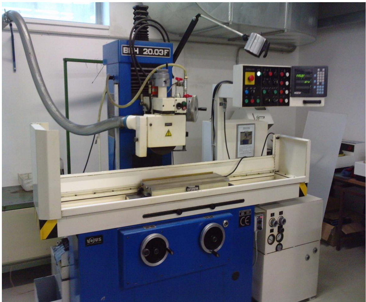
Obrázek 28. Rovinná horizontální bruska BRH 20.03F
