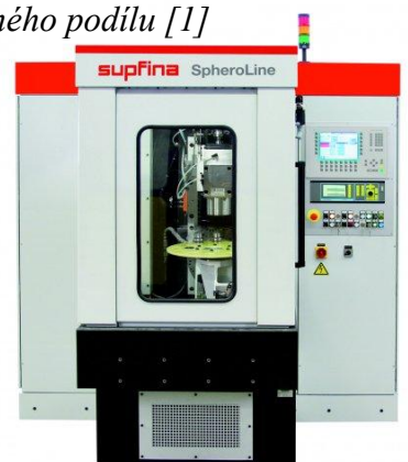
Obrázek 21. Superfinišovací stroj Supfina SpheroLine pro průměr obrobků 18-65 mm [10]
