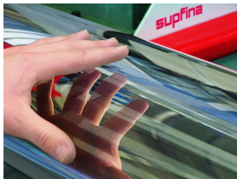
Obrázek 21. Superfinišovací stroj Supfina SpheroLine pro průměr obrobků 18-65 mm [10]
