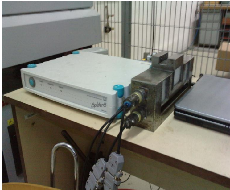
Obrázek 29. Spider8; tenzometrický dynamometr a PC
