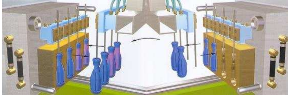
Obr. 10. Princip použití robotů k překládání výlisků [3]
