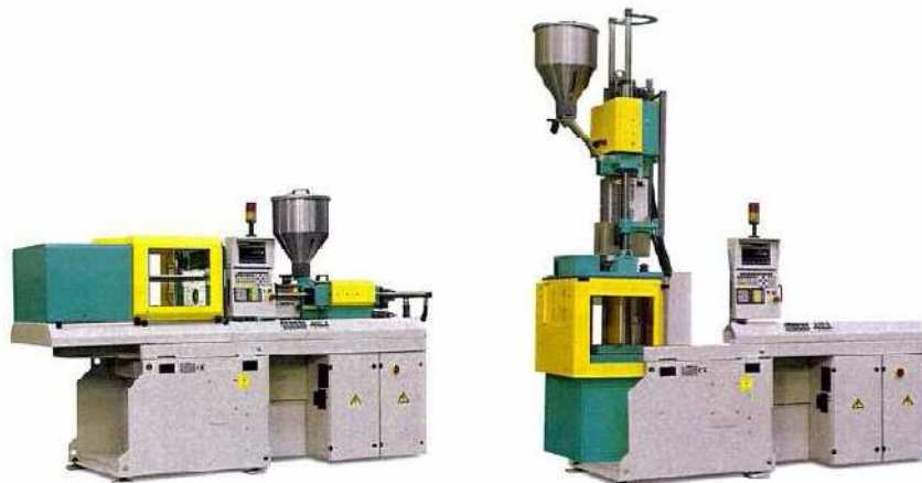
Obr. 29. Vstřikování kolm na dělicí rovinu [3]
