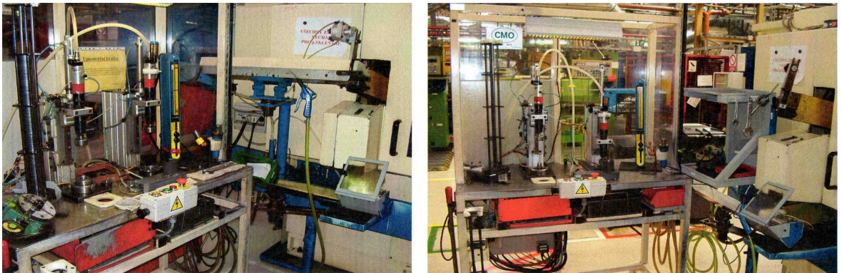
Obrázek 29 Stroj Meccanodora E7 před a po 5S [28]
