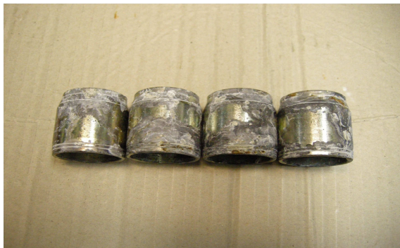
Obr.12 Zinkový povlak po 648 hodinách
