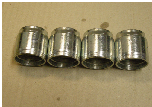
Obr.10 Zinkový povlak po 216 hodinách
