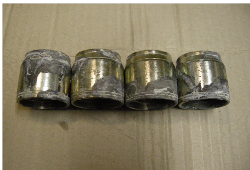
Obr. 11. Zinkový povlak po 576 hodinách
