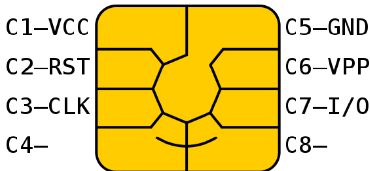
Obr. 5. Kontaktní plošky kontaktní karty.[20]
