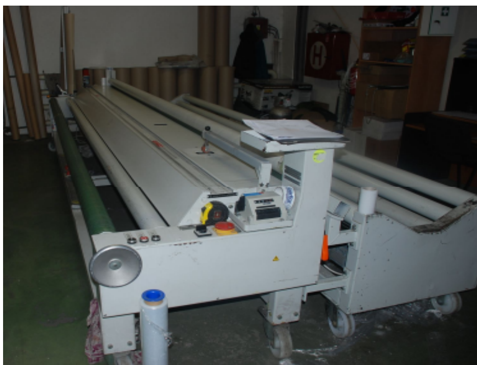
Obr. 3. Řezačka PVC linolea ve skladu PVC podlah
