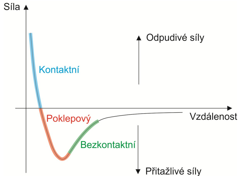
Obr. č. 13 - Síly působící mezi hrotem a vzorkem
