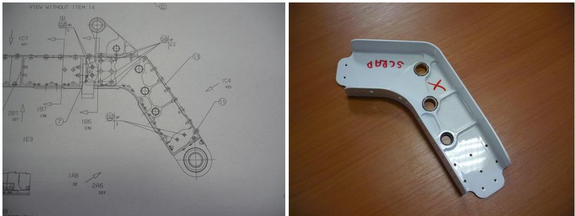
Obrázek 30: Příklad vady - špatně vyvrtané díry v rozporu s výkresem (VZ)
