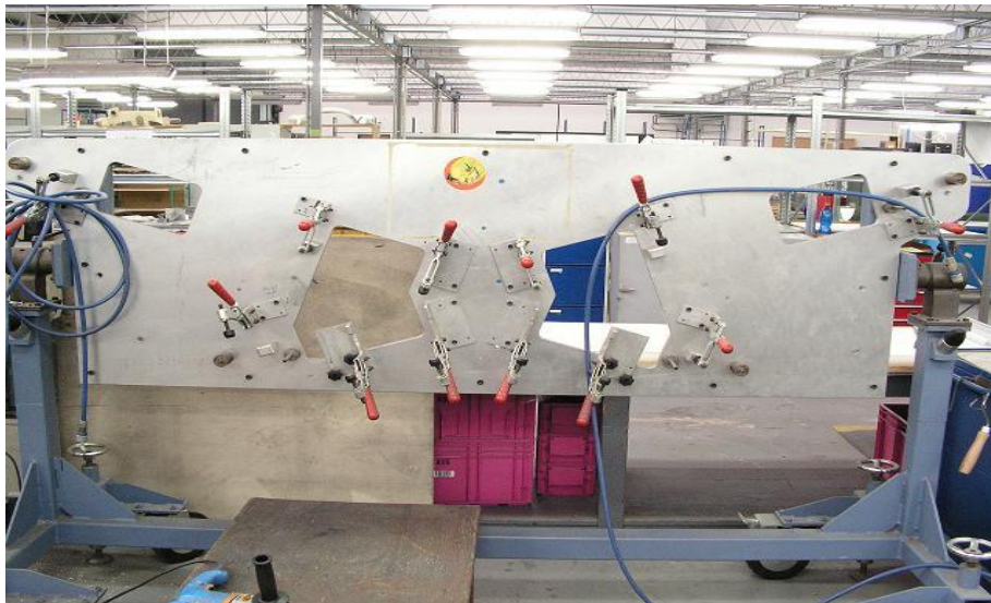
Obrázek 29: Příklad poka-yoke nástroje v AV (VZ)
