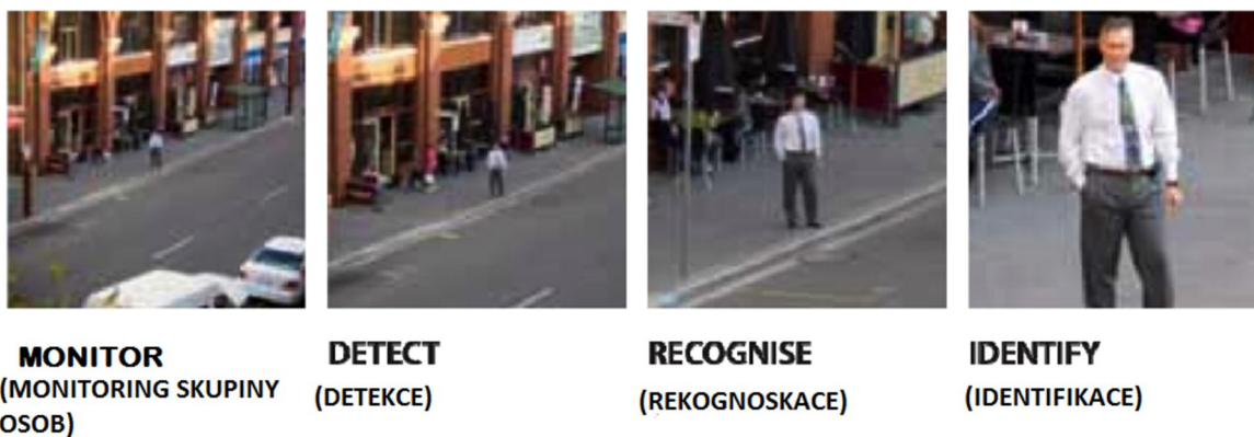
Obr. 5 Stupně identifikace osoby dle ČSN EN 50132-7:1999 (převzato z [22])
