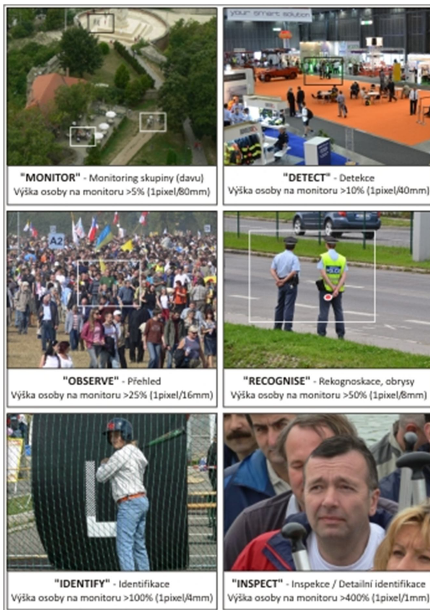
Obr. 6.: Stupně identifikace osoby dle revidované normy EN 50132-7 [12]
