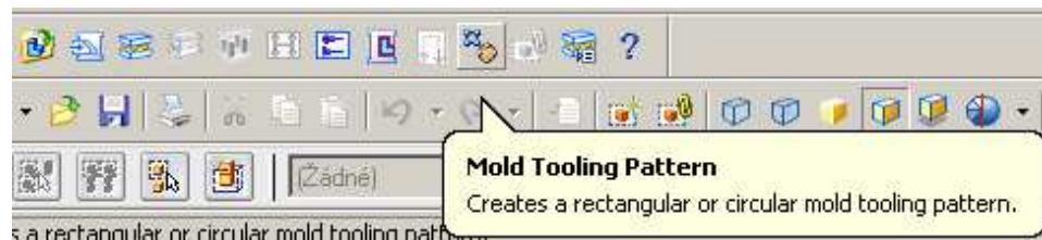
Obr. 41 Panel nástrojů Mold tooling
