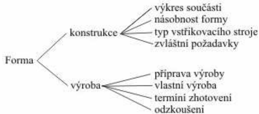
Obr. 5 Technické údaje potřebné pro konstrukci a výrobu formy [1]
