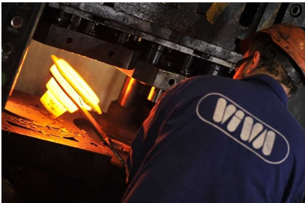
Obrázok 34 Ukážka procesu kovania (interné materiály firmy)
