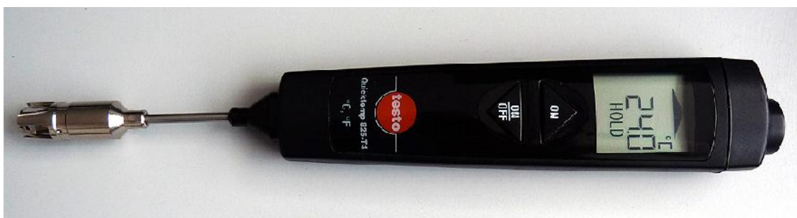
Obrázek 82: Teploměr TESTO - Quicktemp 825 - T4.
