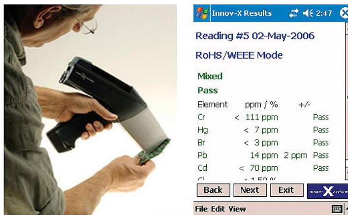
Obrázek 28: Použití spektrometru a výstup analýzy [25]
