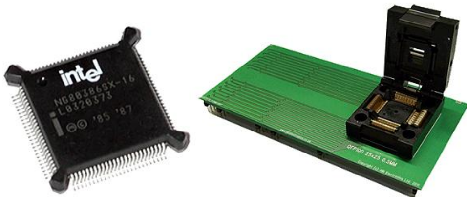
Obrázek 48: Pouzdro QFP a jeho adaptér [42] [43]
