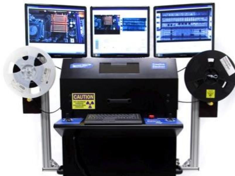
Obrázek 24: Stanoviště rentgenové inspekce
