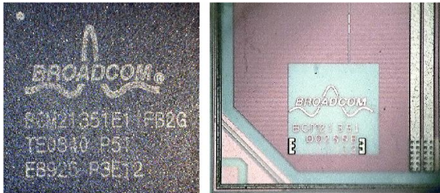
Obrázek 31: Srovnání identifikačních znaků na pouzdrů a vnitřním systému (chipu) [27]
