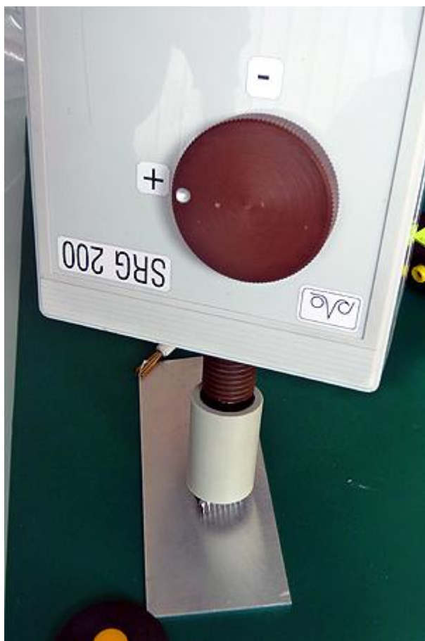
Obrázek 71: Aplikace výboje na obvod.
