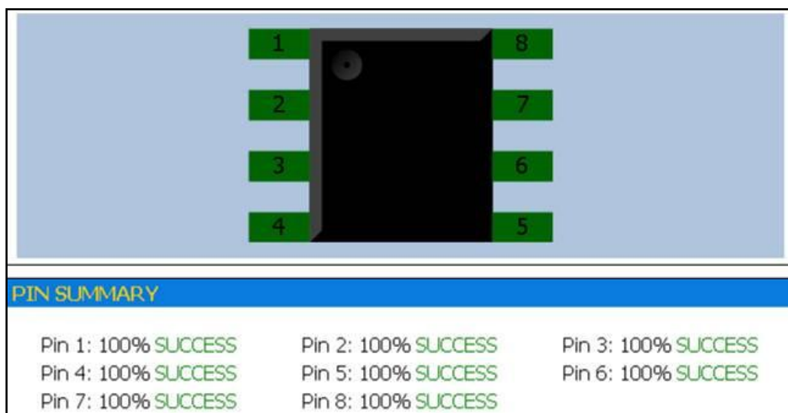
Obrázek 95: Bezchybné vyhodnocení testu 555-SMD po vystavení teplotě 250 °C
