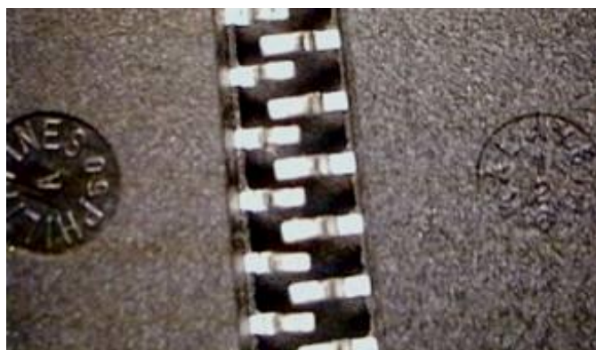
Obrázek 20: Překryté značení na spodní straně (vlevo originál) [13]
