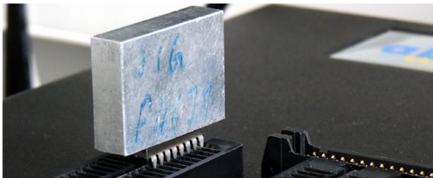
Obrázek 84: Umístění zahřátého hranolu na součástku
