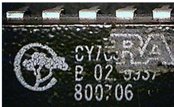
Obrázek 14: Příklad přeznačené součástky, povrch Altera přeznačeno na Cypress [13]
