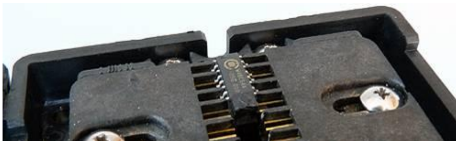
Obrázek 50: Vložený obvod SMD v adaptéru SOIC.
