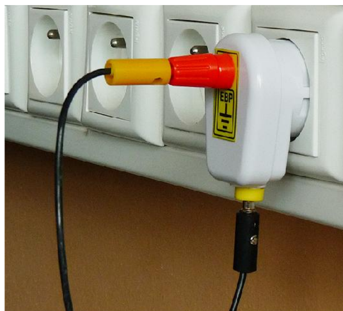
Obrázek 70: Uzemnění přes zásuvku
