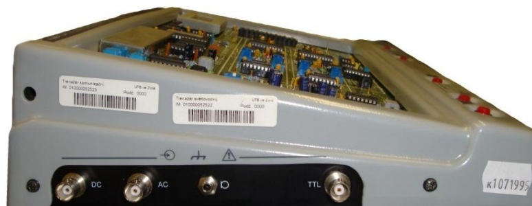
Obr. 21: Vstupy multifunkčního vysílače.
