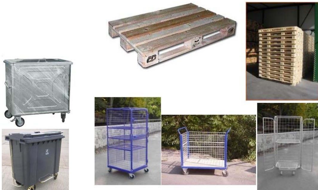
Obrázek 10: Příklad manipulačních jednotek II. řádu
