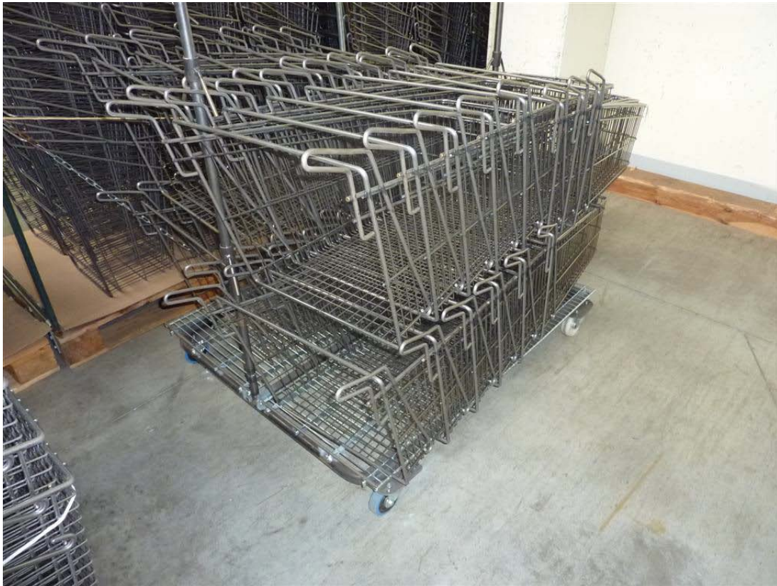
Obrázek 25: Vozík pro přepravu košů I. typu
