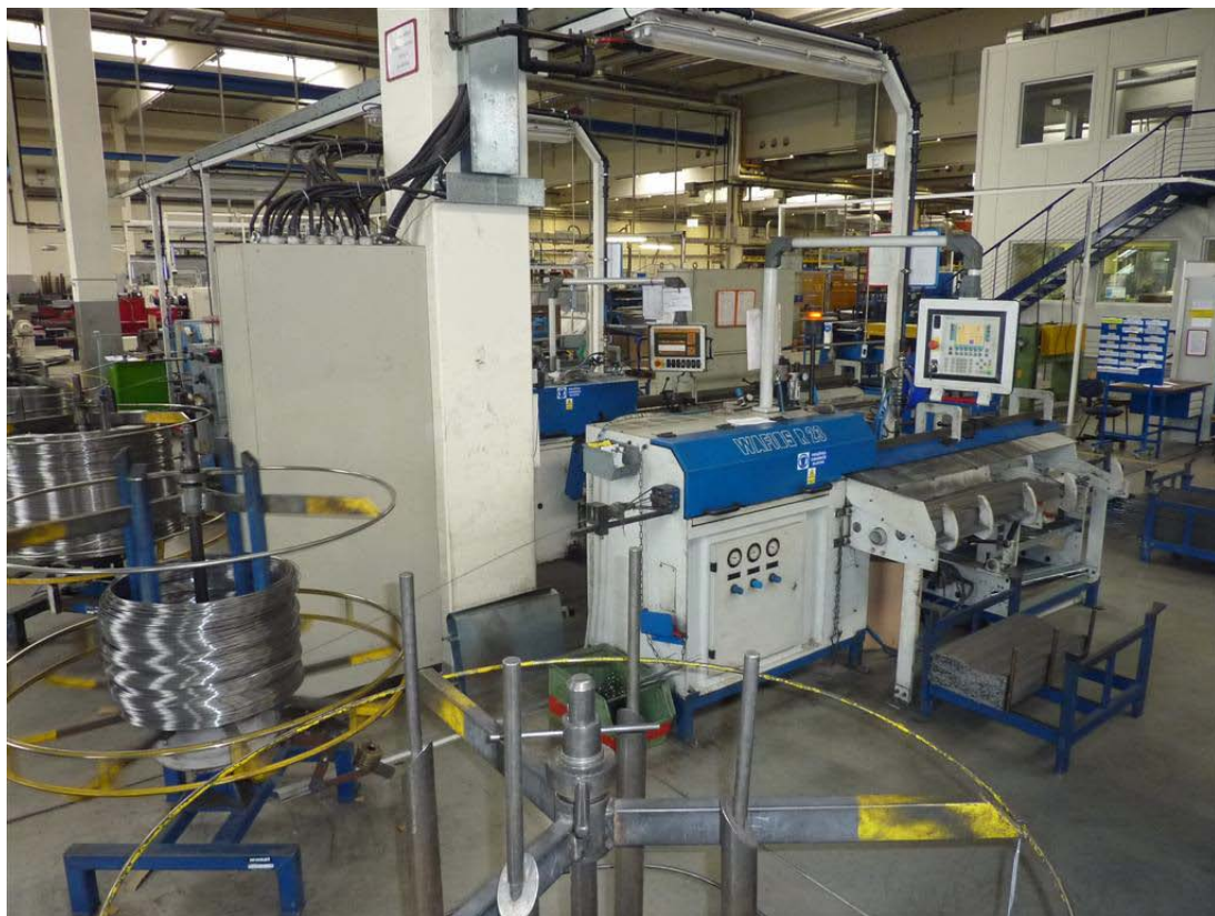
Obrázek 14: Stříhačka drátu Wafios R23
