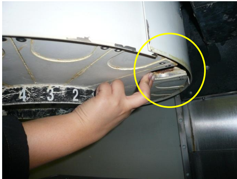
Obrázek 30: Karuselové kapsy se špatně otevírají - může dojít k nabourání stroje (vlastní)
