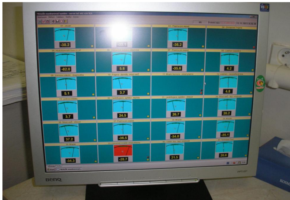
Obrázek 14 - PC hlídá teploty ve skladovacích zařízeních
