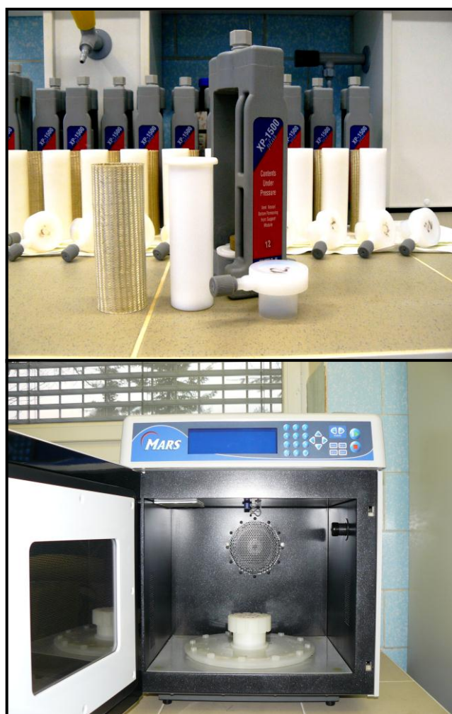
Obrázek 8: Mikrovlnný rozklad vzorků svaloviny foto: Andrej Migal'a
