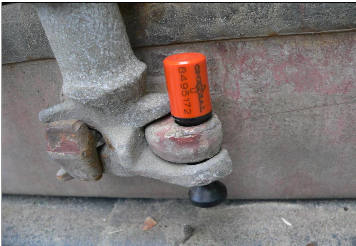
Obr. č. 16 Kontrolní zajištění kontejneru, proti neoprávněnému otevření [18]
