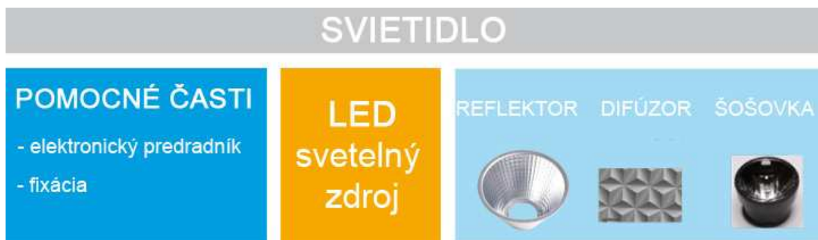
Obr. č.11: zjednodušená funkčná schéma LED svietidla (zdroj: www.omslighting.sk )
