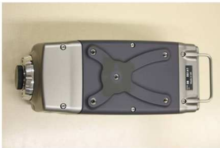
Obr. 6. Systém uchytenia kamery ku statívu [5].
