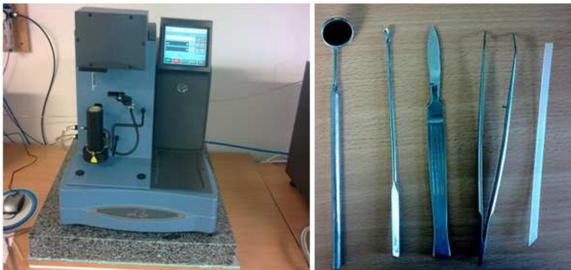
Obrázok 27 – Termogravimeter TGAQ500 od spoločnosti TA Instruments (vľavo), používané pomôcky pri manipulácii so vzorkou, zľava: zrkadlo, lyžička, skalpel, pinzeta, pomôcka pre čistenie dna pánvičky (vpravo).
