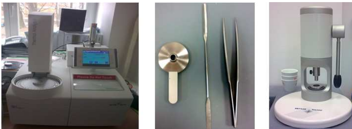
Obrázok 26 - Použitie DSC zariadenie DSC1 STAR E SYSTEMS od spoločnosti METTLER TOLEDO (vľavo), použité pomôcky zľava: držiak panvičky, lyžička, pinzeta (stred), ručný lis od spoločnosti METTLER TOLEDO (vpravo).
