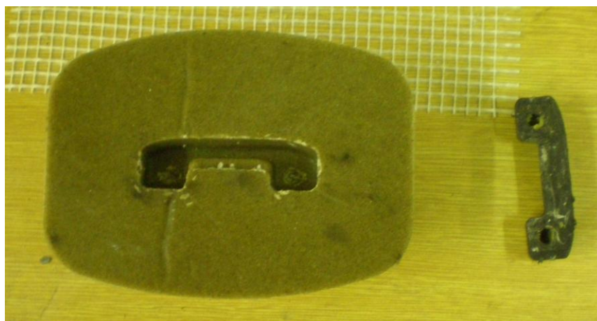
Obr. 19. Odformování tvarové části polymerbetonové formy
