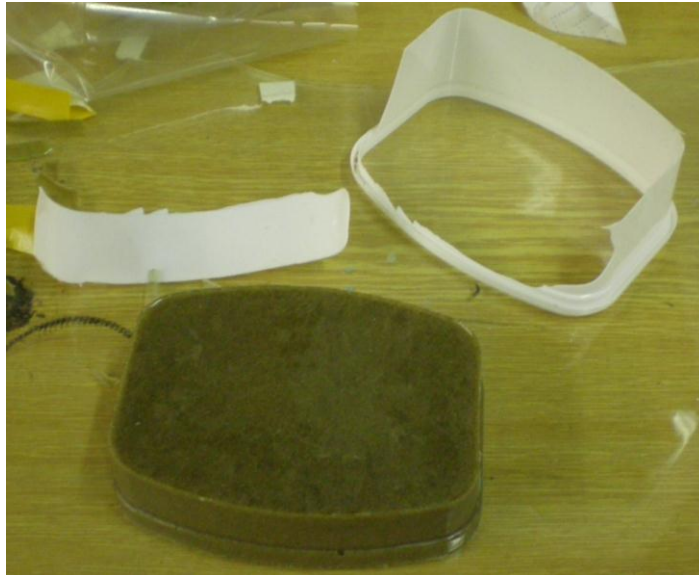
Obr. 18. Odformování polymerbetonové formy
