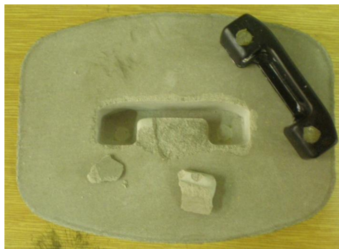
Obr. 15. Odformování tvarové části betonové formy
