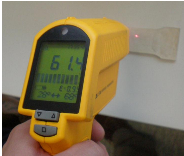
Obr. 23. Měření teplot infračerveným teploměrem
