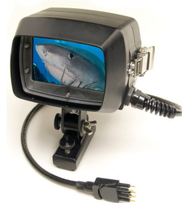
obr. č. 34 externí monitor s úhlopříčkou 4,3"
