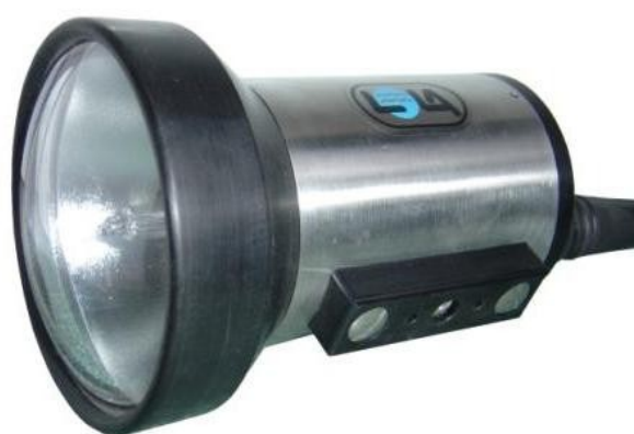
obr. č. 19 Xenon HID parabola s konvexním sklem a vyzařovacím úhlem 120°
