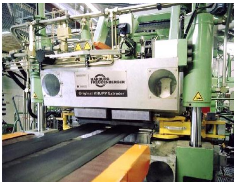
Obr. 12 Vytlačovací hlava KRUPP [18]
