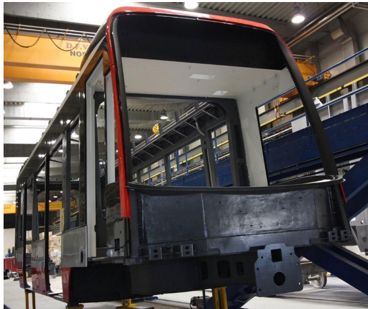
Obr. 63 Namontovaný čelní modul k vozu [28]
