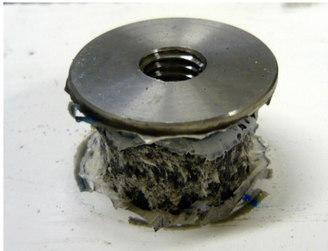
Obr. 71 Vytržená závitová vložka
