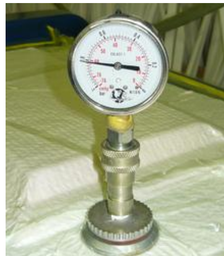
Obr. 55 Vytvoření vakua 0,8 bar
