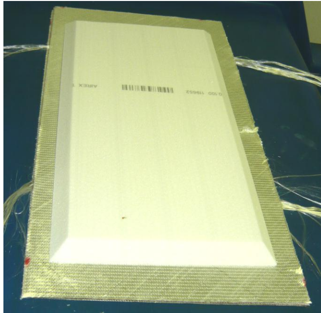
Obr. 50 Umístění jádra na prepreg
