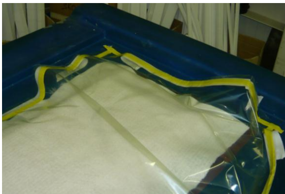
Obr. 54 Aplikace těsnicí pásky -200Y Sealant Tape
