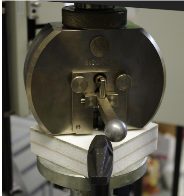
Obr. 69 Upnutí při trhacím testu záv. vložky
