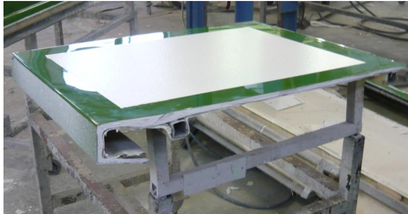
Obr. 56 Připravená vytvrzená vtrsva gelcoatu
