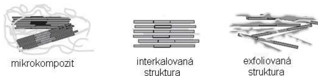
Obr. č. 14 Typy struktur nanokompozitů polymer/jíl[33]
