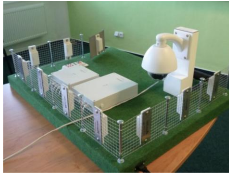
Obr. 10. Model systému perimetrické ochrany za pomoci RFID. [5]
