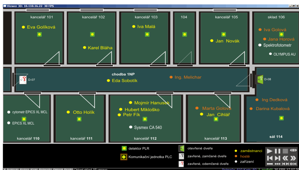
Obr. 8. RTLS vizualizace osob a zařízení v 3D modelu objektu. [5]
