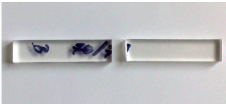
Obr. 22 Zlomení vzorku vypáleného při výkonu laseru 70 % a posuvu 7 %
