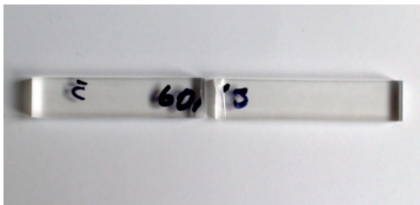
Obr. 26 Zlomení vzorku vypáleného při výkonu laseru 60 % a posuvu 5 %
