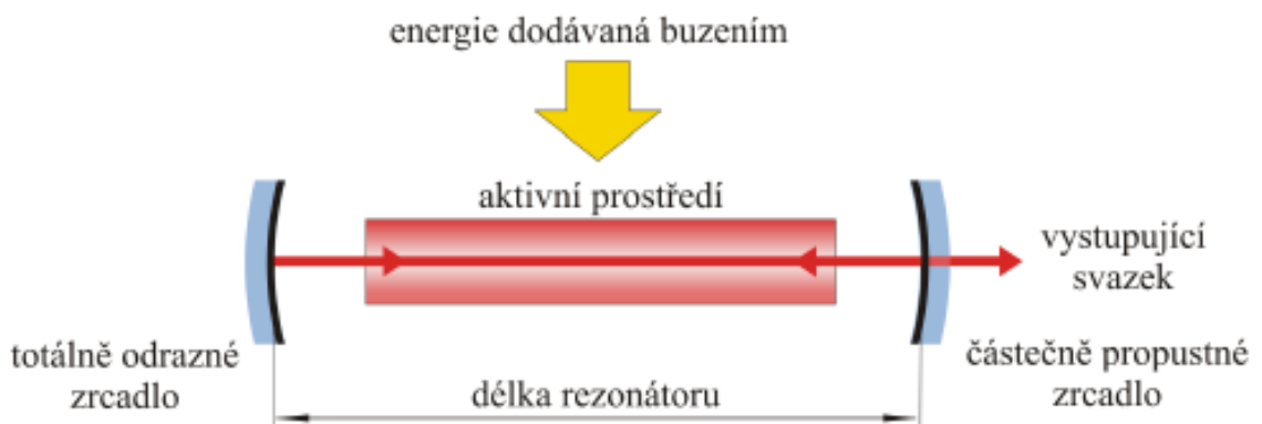
Obr. 3 Schéma optického rezonátoru[1]
