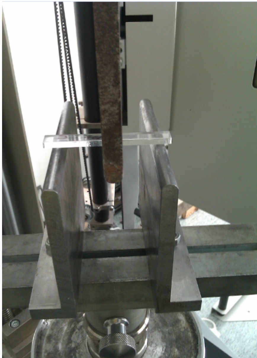
Obr. 20 Podpěry a zátěžovací trn stroje ZWICK ROELL 1456
