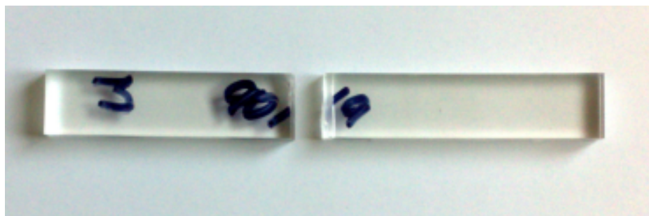
Obr. 34 Zlomení vzorku vypáleného při výkonu laseru 90 % a posuvu 9 %
