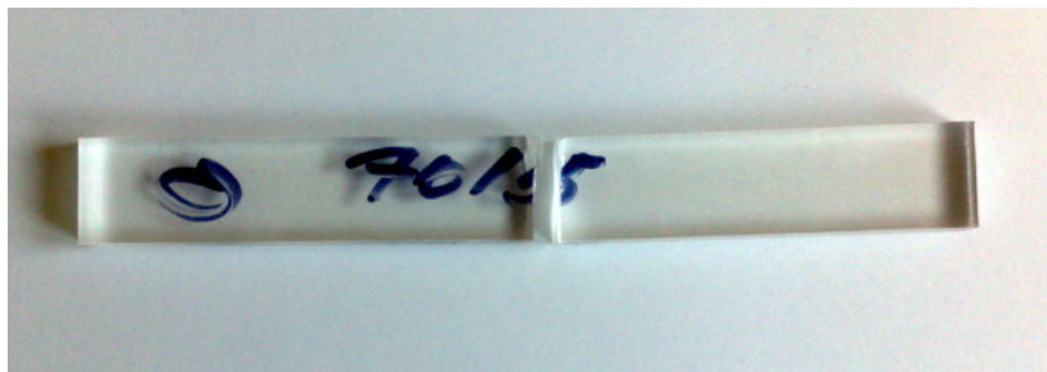
Obr. 38 Zlomení vzorku vypáleného při výkonu laseru 70 % a posuvu 5 %
