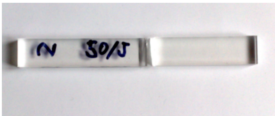
Obr. 30 Zlomení vzorku vypáleného při výkonu laseru 50 % a posuvu 5 %
