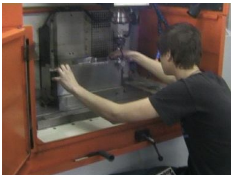
Obr. 22. Zaměřování souřadnic obrobku
